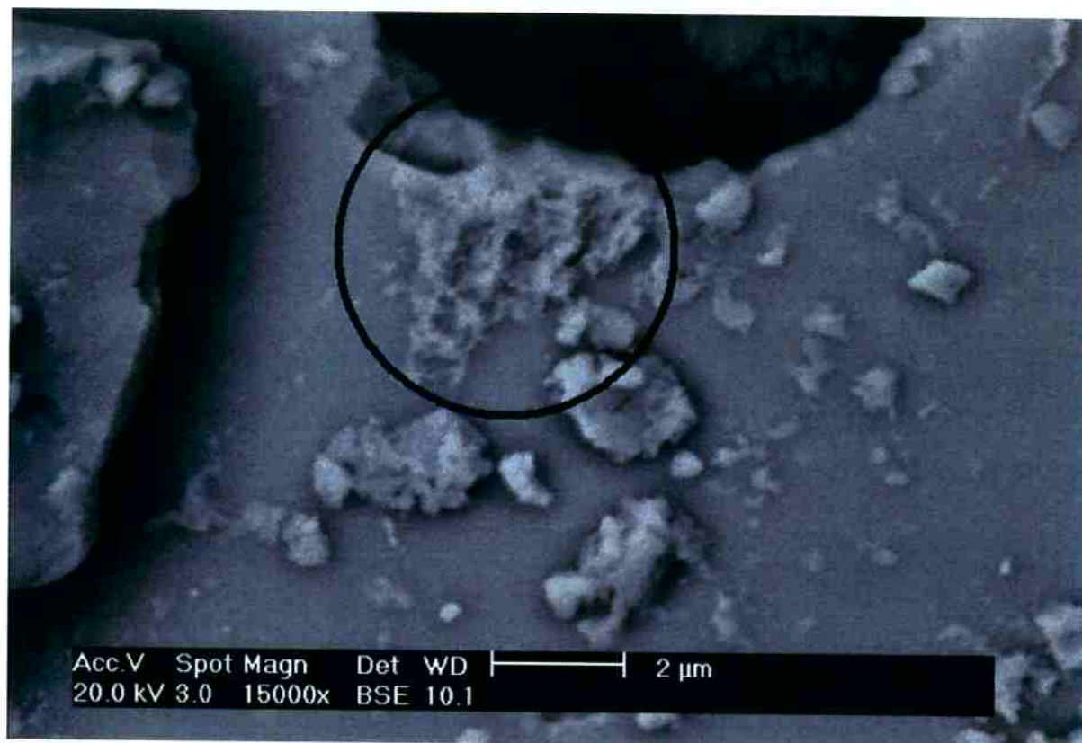
Ilustração 21: Imagem realizada no MEV da superfície de um floco de MQP-A com retroespalhamento e aumento de 15000x. A região demarcada indica uma possível morfologia de oxidação.
