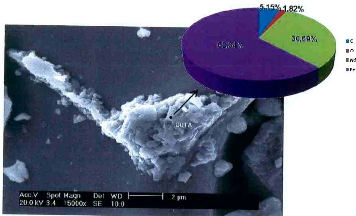
Ilustração 23: Noutra formação semelhante, o mesmo procedimento foi realizado (15000x de aumento em MEV com elétrons secundários seguido de EDS indicado).
