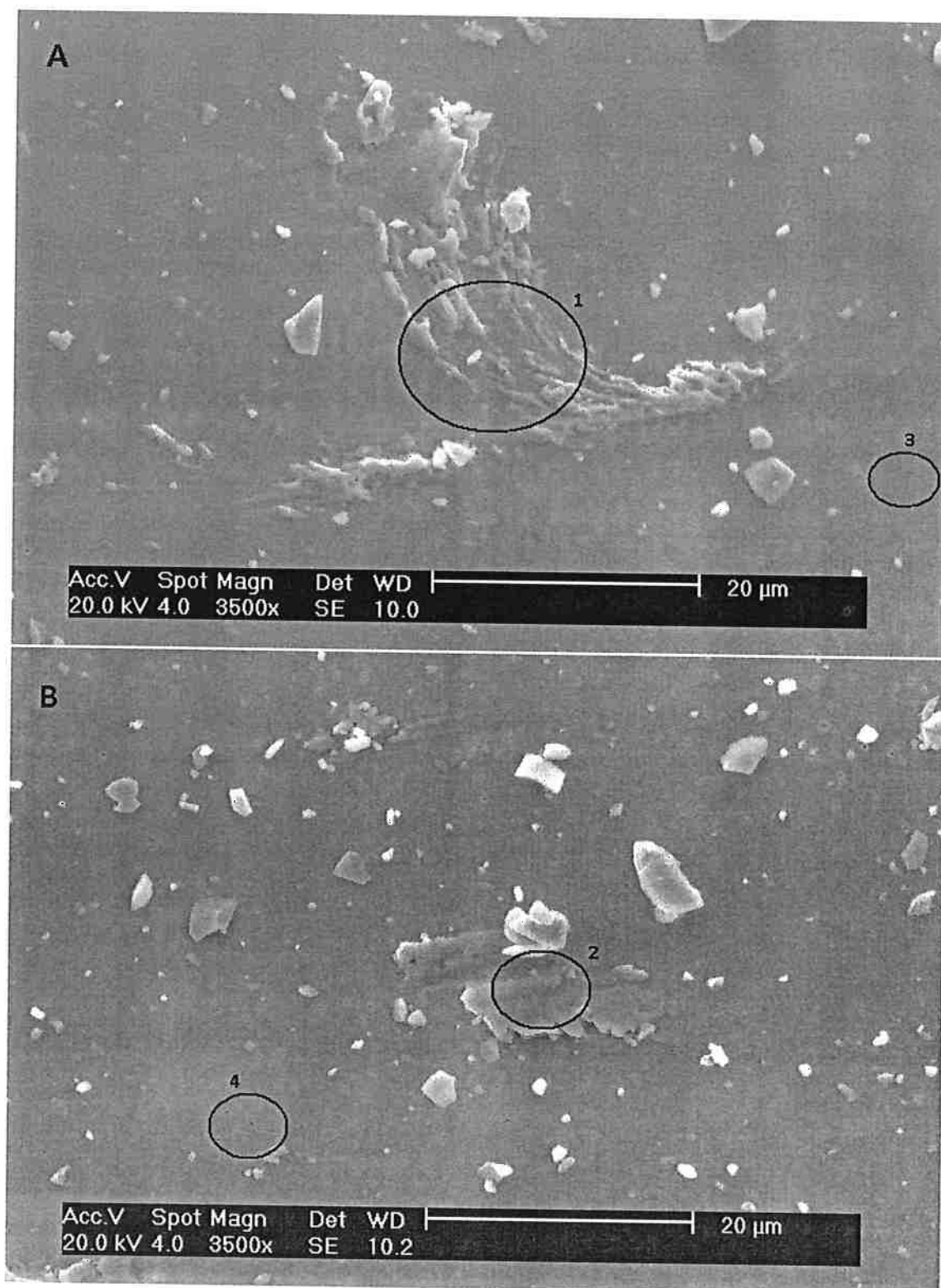
Ilustração 34: Imagens reproduzidas no MEV usando elétrons secundários com 3500x de aumento de uma amostra não-envelhecida (a) e outra envelhecida (b) de MQP-A. Os círculos mostram os lugares onde as próximas ampliações serão feitas.
